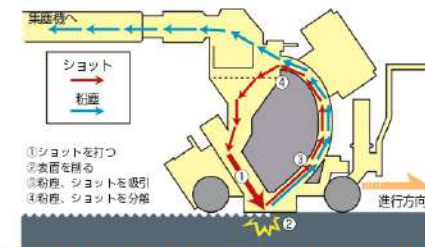
高速回転する羽根車の遠心力によりショットを処理面に打ちつけ、その衝突エネルギーで表面の材料を削り取る
