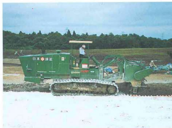
▲スーパーディープスタビライザ〈トレンチャ方式〉(最大混合深さ100cm)
