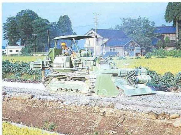
▲ベース スタビライザ〈タインロータ方式〉(最大混合深さ42cm)
