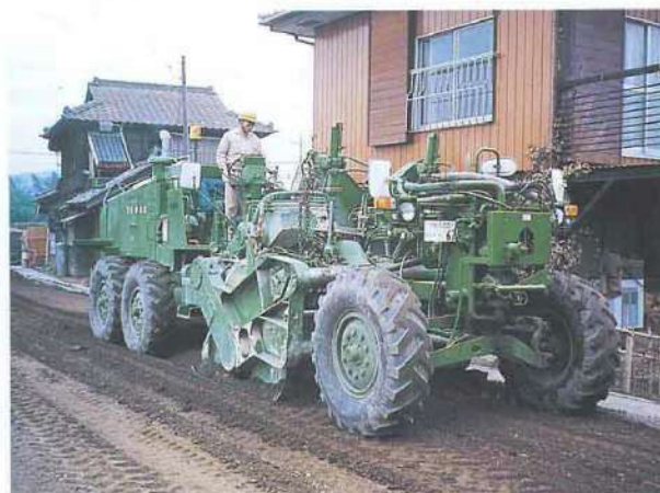
▲ディープスタビライザ〈タインロータ方式〉(最大混合深さ50cm)
