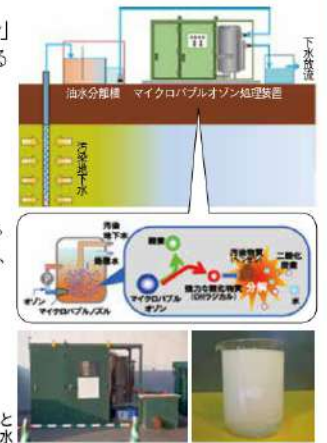
マイクロバブルオゾン処理装置とマイクロバブルオゾン水
